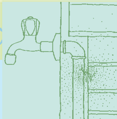
Feine Risse an Rohrleitungen führen zu einem versteckten Wasserschaden.
