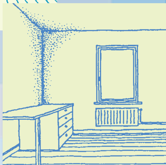
Kondenswasserbildung in einer ungedämmten Außenwanddecke nach einer Isolierverglasung
