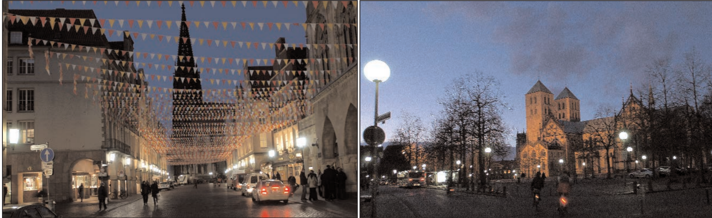
Aktuell vorhandener Einsatz von Leuchten an prominenten Stellen der Stadt. Indifferentes Raumlicht mit hohen Farbtemperaturen herrscht - neben flächiger Distanzanstrahlung - vor. Hohe Leuchtdichten und hohe Farbtemperaturen produzieren Punktmuster mit aufdringlicher Präsenz.
